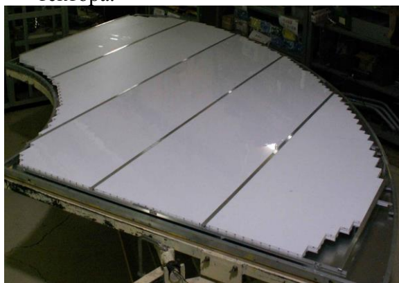
Два сектора детектора для идентификации мюонов и восстановления долгоживущих нейтральных каонов эксперимента Belle-2.
