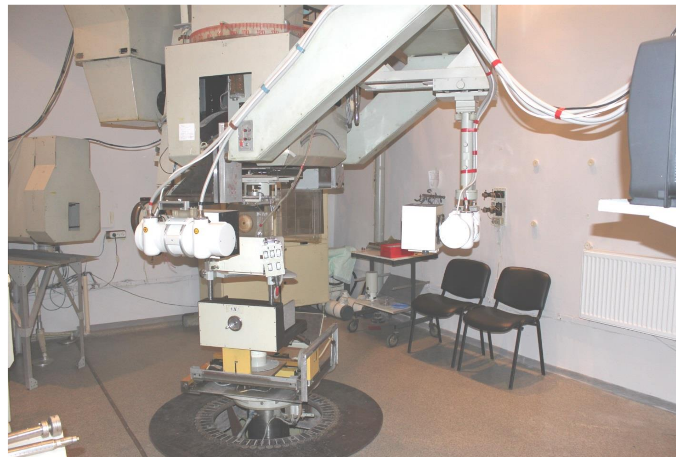
Рис.5. Лучевая установка для облучения опухолей глаза, орбиты, головы, шеи, верхней части туловища
